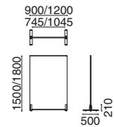
※3連、2連タイプの左右のパネルは、図面のように同一方向で曲げていただくか、もしくは左の画像のように異なる方向に各々90°以上135°以下で設定してください。
