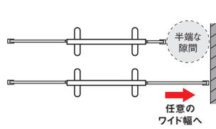
任意に引き出し可能なスライドパネルで、従来のパネルではカバーできなかった半端な隙間を解消できます。
