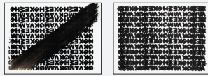
既存インク 新開発インク ※感熱紙に捺印して一定時間経過したものを上からこすった比較画像。既存インクは乾きにくく、定着しにくい。(用紙の種類によって個体差あり)
