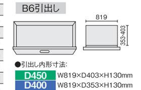
●引出し内形寸法: D450 W819×D403×H130mm D400 W819×D353×H130mm
